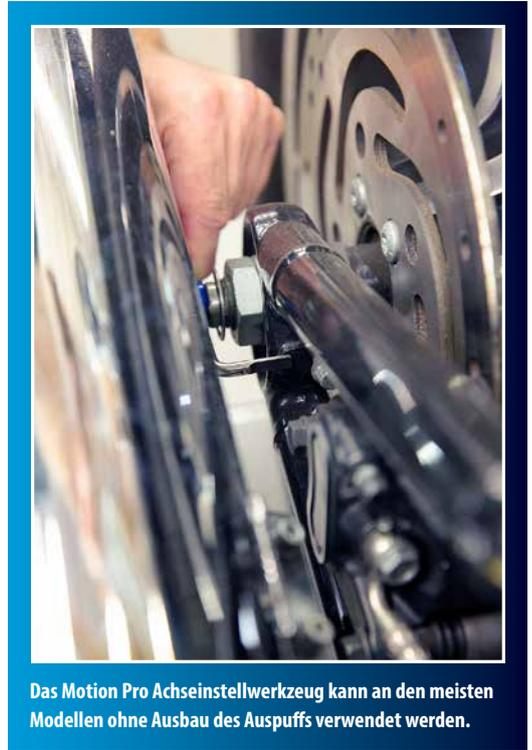
Das Motion Pro Achseinstellwerkzeug kann an den meisten Modellen ohne Ausbau des Auspuffs verwendet werden.
