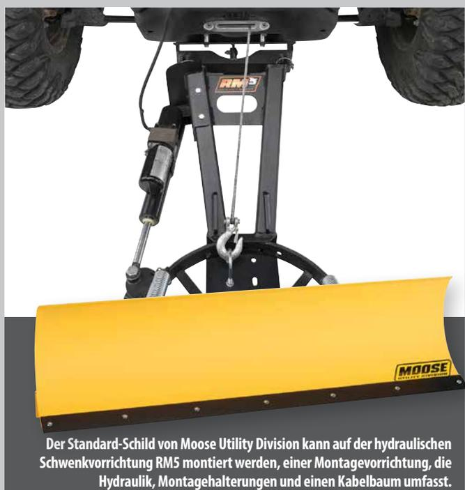
Der Standard-Schild von Moose Utility Division kann auf der hydraulischen Schwenkvorrichtung RM5 montiert werden, einer Montagevorrichtung, die Hydraulik, Montagehalterungen und einen Kabelbaum umfasst.
