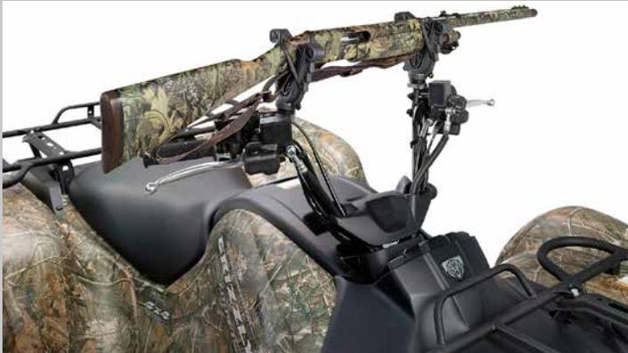
Der V-Grip Lenker-Gewehrhalter von Moose Utility Division ermöglicht die Befestigung eines Gewehrs oder eines Bogens am vorderen Lenker eines ATVs.
