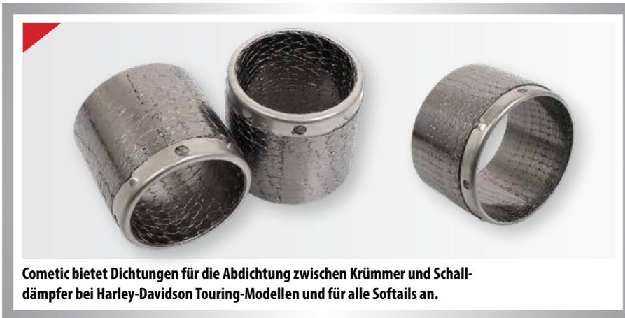
Cometic bietet Dichtungen für die Abdichtung zwischen Krümmer und Schalldämpfer bei Harley-Davidson Touring-Modellen und für alle Softails an.
