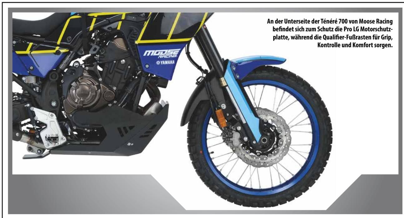
An der Unterseite der Ténéré 700 von Moose Racing befindet sich zum Schutz die Pro LG Motorschutzplatte, während die Qualifier-Fußrasten für Grip, Kontrolle und Komfort sorgen.
