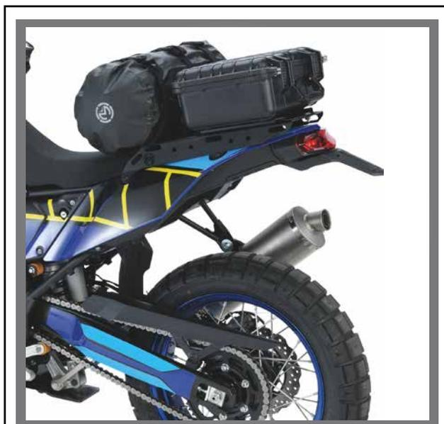
Eine der absoluten Notwendigkeiten beim Adventure-Fahren ist das richtige Gepäck. Für die Ténéré bedeutete das, mit dem ADV Gepäckträgersystem von Moose Racing zu beginnen, das mehrere Aufnahmepunkte für Spann- und Aussparungen für Taschengurte oder elastische Gurte bietet.
