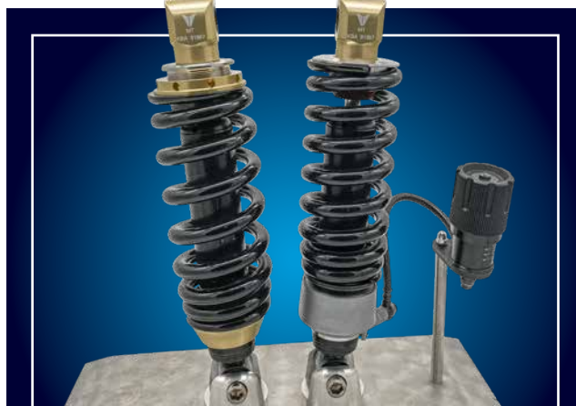
Le kit de rabaissement Müller Motorcycle est compatible avec toutes les machines M8 Softail et est réglable en continu jusqu'à 1,6 pouce (40 mm). Il est idéal pour ceux qui cherchent à améliorer l'ergonomie de leur moto.
