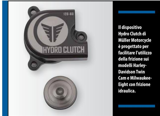
Per apportare ulteriori miglioramenti, sia Power Clutch sia Hydro Clutch sostituiscono un segmento della frizione OEM e non sono necessari fori o distanziali. E, dall'esterno, non ci sono prove che un motociclista stia facilitando la guida grazie a Müller Motorcycle. ■
