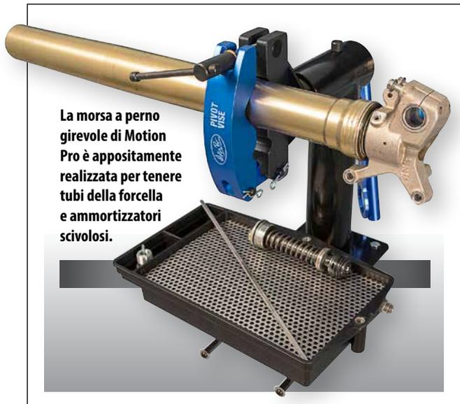
La morsa a perno girevole di Motion Pro è appositamente realizzata per tenere tubi della forcella e ammortizzatori scivolosi.
