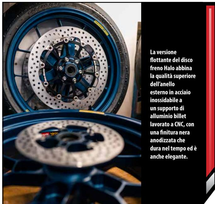
La versione flottante del disco freno Halo abbina la qualità superiore dell'anello esterno in acciaio inossidabile a un supporto di alluminio biliet lavorato a CNC, con una finitura nera anodizzata che dura nel tempo ed è anche elegante.
