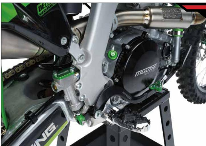
Moose Racing lieferte auch die verbesserte Fußrastenanlage, einschließlich Schalthebel, Bremspedal und Hybrid-Fußrasten. Bei diesem Motorrad kommt es auf die Details an und die kommen hier nicht zu kurz.
