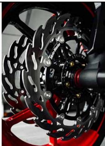
Die Bremsscheiben der Flame-Serie von Moto-Master sind sowohl in schwimmender als auch in starrer Ausführung für viele Modelle erhältlich. Das einzigartige Flammendesign sieht großartig aus und bietet eine optimale Kühlung, damit die Bremsen zuverlässig und berechenbar bleiben.
