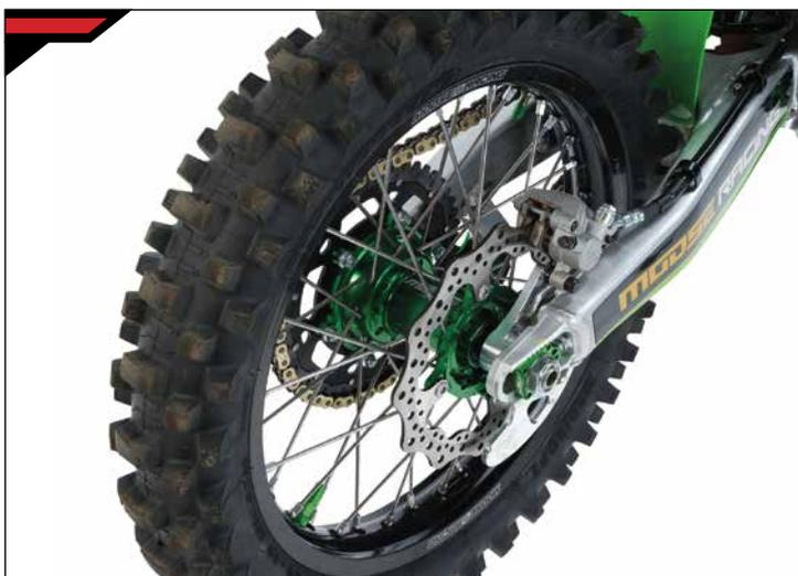
Hinten hat die Kawasaki ein zweiteiliges Moose Racing Kettenrad, einen Shark Fin Bremsscheibenschutz und eine RFX Bremsscheibe.
