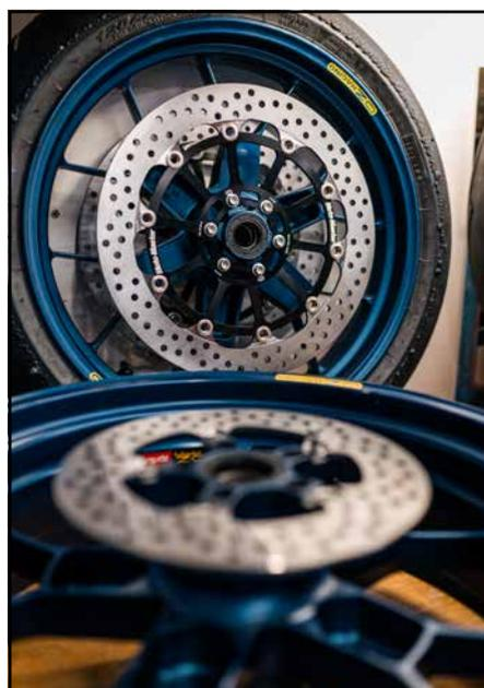
Bei der Halo-Bremsscheibe wird der Außenring aus hochwertigem Edelstahl mit einem CNC-gefrästen Billet-Aluminiumträger kombiniert, der für eine dauerhafte, attraktive Oberfläche schwarz eloxiert ist.
