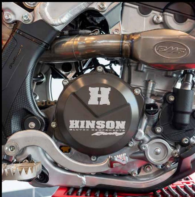
La Honda CRF250R del concorso ad estrazione è stata equipaggiata con un coperchio frizione lavorato di precisione e con rivestimento duro Hinson.
