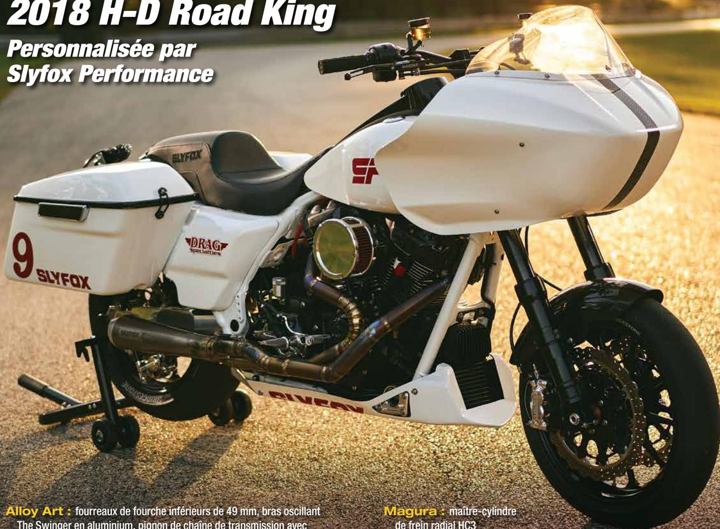
**Alloy Art** : fourreaux de fourche inférieurs de 49 mm, bras oscillant The Swinger en aluminium, pignon de chaîne de transmission avec amortisseur de couple à 53 dents
