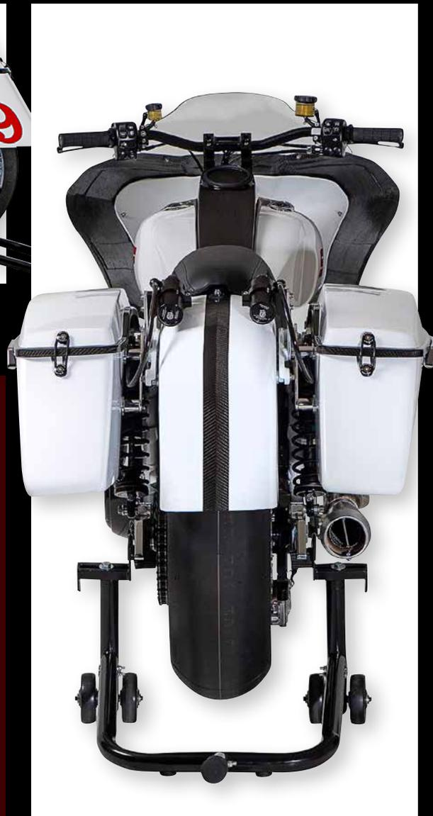
Le moteur qu'Alex Fox et l'équipe SLYFOX ont construit, avec sa transmission de 124 pouces S&S Cycle et sa distribution Feuling complète perfectionnée, est paré pour la course. Les pneus slick Bridgestone pour la course montés sur les roues SLYFOX Track-Pro de 6 pouces de large apportent de la puissance à la moto. Ils sont protégés par un garde-boue en fibre de carbone SLYFOX et entourés de sacoches et couvercles dans le même matériau.
