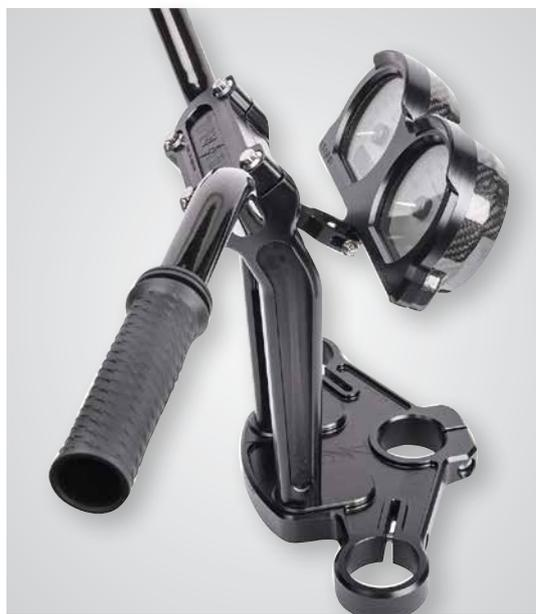
Le nouveau kit de déport d'indicateurs de THRASHIN fonctionne avec les risers OG et Holeshoot de l'entreprise et permet aux motards de positionner leurs indicateurs devant ou derrière les risers ainsi que de régler leur inclinaison.
