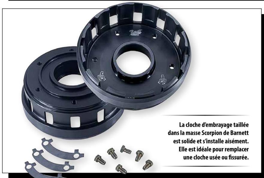
La cloche d'embrayage taillée dans la masse Scorpion de Barnett est solide et s'installe aisément. Elle est idéale pour remplacer une cloche usée ou fissurée.
