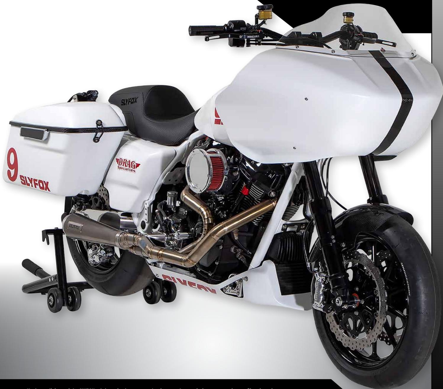
Un éventail de produits SLYFOX a été employé pour ce projet de moto. Les garde-boue et sacoches en fibre de carbone pour un poids moindre, et le carénage et le réceptacle inférieur uniques également en fibre de carbone, ont été complétés par des roues et des disques de frein SLYFOX. L'échappement 100 % titane a été conçu conjointement par SLYFOX et Bassani.
