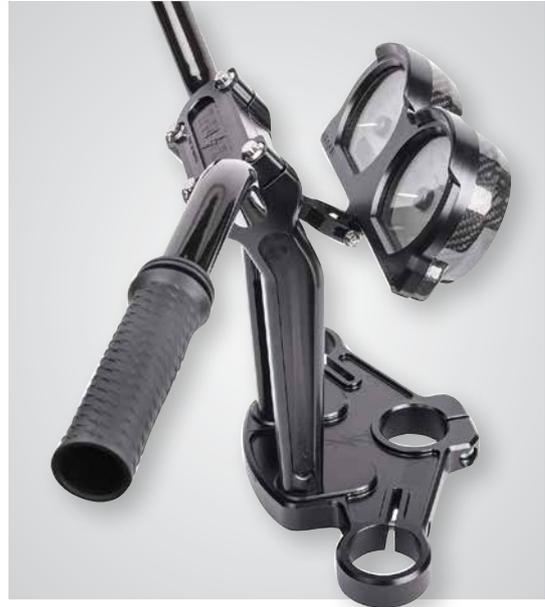
El nuevo kit reubicador de instrumentos de THRASHIN funciona con las torretas OG y Hoeshot de esta empresa y permite a los pilotos colocar sus instrumentos delante o detrás de las torretas y ajustar el ángulo de los instrumentos.
