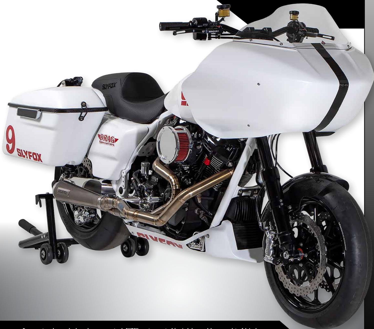
Por supuesto, se han empleado muchos componentes de SLYFOX en este proyecto. Además de los guardabarros y maletas fabricados en fibra de carbono para reducir el peso, y el carenado y la quilla de diseño único, las ruedas y discos de freno también llevan la marca SLYFOX. El escape fabricado enteramente en titanio es el fruto de la colaboración entre SLYFOX y Bassani.
