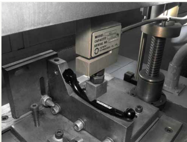
Accossato sottopone le proprie leve a test approfonditi per verificarne la forza, un passaggio essenziale del processo di ricerca e sviluppo dell'azienda.
