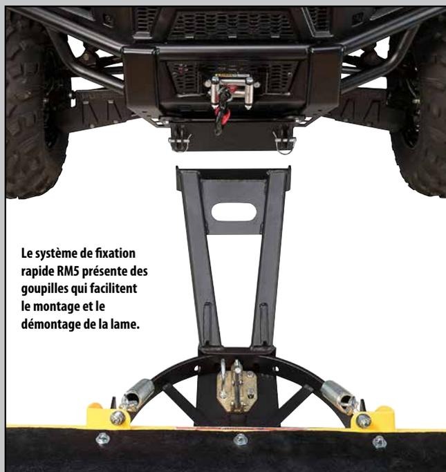
Le système de fixation rapide RM5 présente des goupilles qui facilitent le montage et le démontage de la lame.
