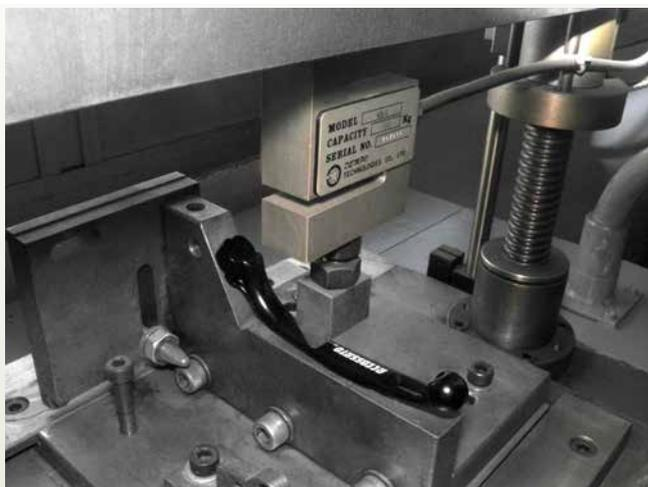
Accossato réalise de nombreux tests afin de vérifier la robustesse de ses leviers, facteur essentiel du processus de recherche et développement de l'entreprise.
