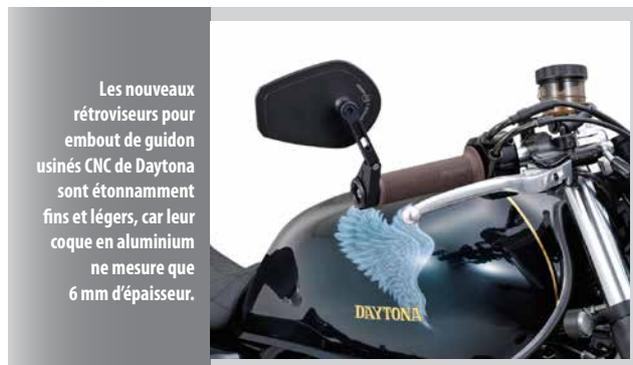
Les nouveaux rétroviseurs pour embout de guidon usinés CNC de Daytona sont étonnamment fins et légers, car leur coque en aluminium ne mesure que 6 mm d'épaisseur.
