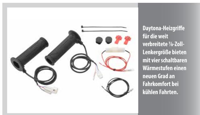
Daytona-Heizgriffe für die weit verbreitete 7/8-Zoll-Lenkergröße bieten mit vier schaltbaren Wärmestufen einen neuen Grad an Fahrkomfort bei kühlen Fahrten.
