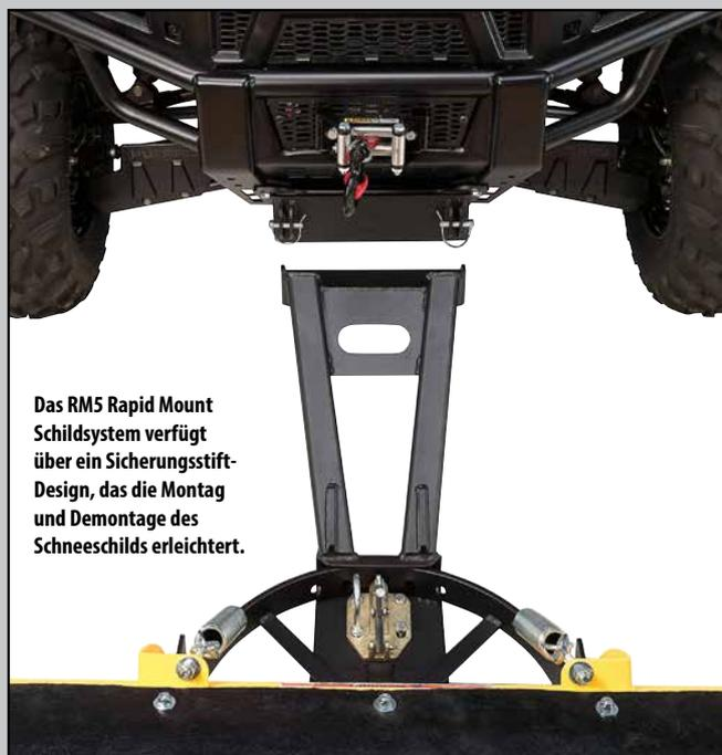
Das RM5 Rapid Mount Schildsystem verfügt über ein Sicherungsstift-Design, das die Montag und Demontage des Schneeschildes erleichtert.
