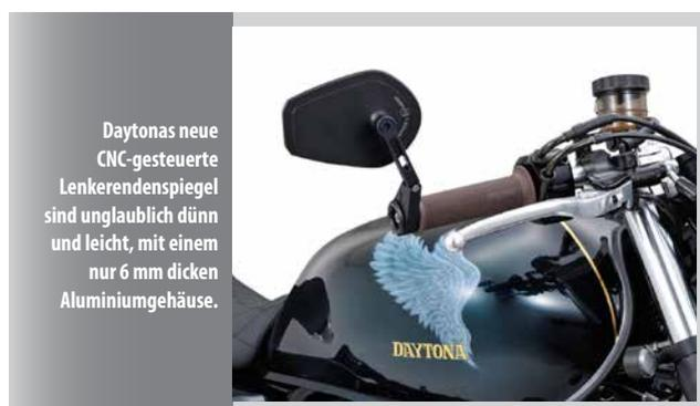
Daytonas neue CNC-gesteuerte Lenkerendspiegel sind unglaublich dünn und leicht, mit einem nur 6 mm dicken Aluminiumgehäuse.
