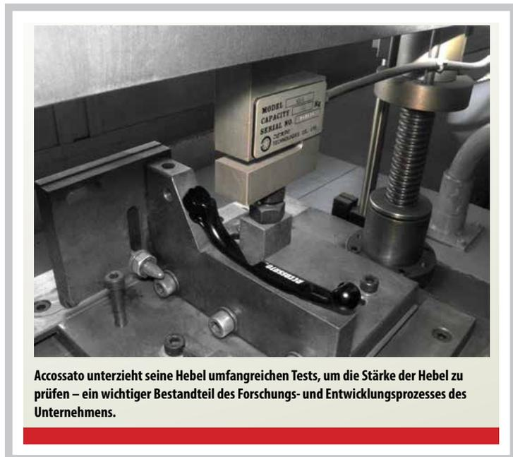
Accossato unterzieht seine Hebel umfangreichen Tests, um die Stärke der Hebel zu prüfen – ein wichtiger Bestandteil des Forschungs- und Entwicklungsprozesses des Unternehmens.
