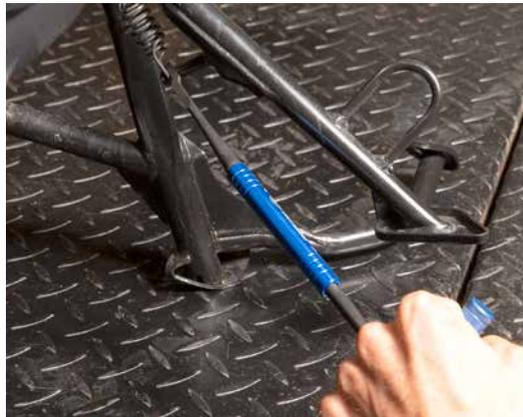
Der Tuff Hook von Motion Pro ist ein großartiges Werkzeug für den Umgang mit schwierigen Federn. Die Spitze des Werkzeugs verfügt über eine Kerbe, um schwer erreichbare Federn von ihren Halterungen zu drücken.
