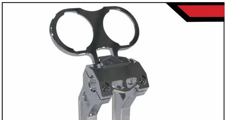
Le pontet supérieur des risers performance sert également de zone de montage pour les trois variantes de supports d'indicateur de LA Choppers.
