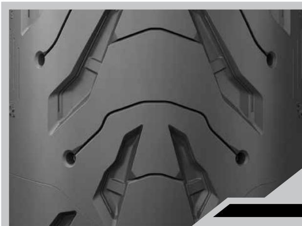
Les lamelles du pneu MICHELIN Road 6 s'élargissent à mesure que ce dernier s'use, aidant à maintenir sa capacité d'évacuation de l'eau.
