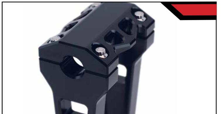
Le pontet supérieur mesure soit 25 mm (1 pouce), soit 31,75 mm (1¼ pouce) de diamètre et intègre de solides vis de montage ARP en 12 points.
