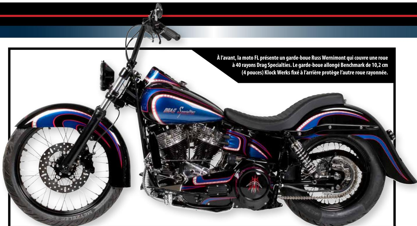
À l'avant, la moto FL présente un garde-boue Russ Wernimont qui couvre une roue à 40 rayons Drag Specialties. Le garde-boue allongé Benchmark de 10,2 cm (4 pouces) Klock Werks fixé à l'arrière protège l'autre roue rayonnée.
