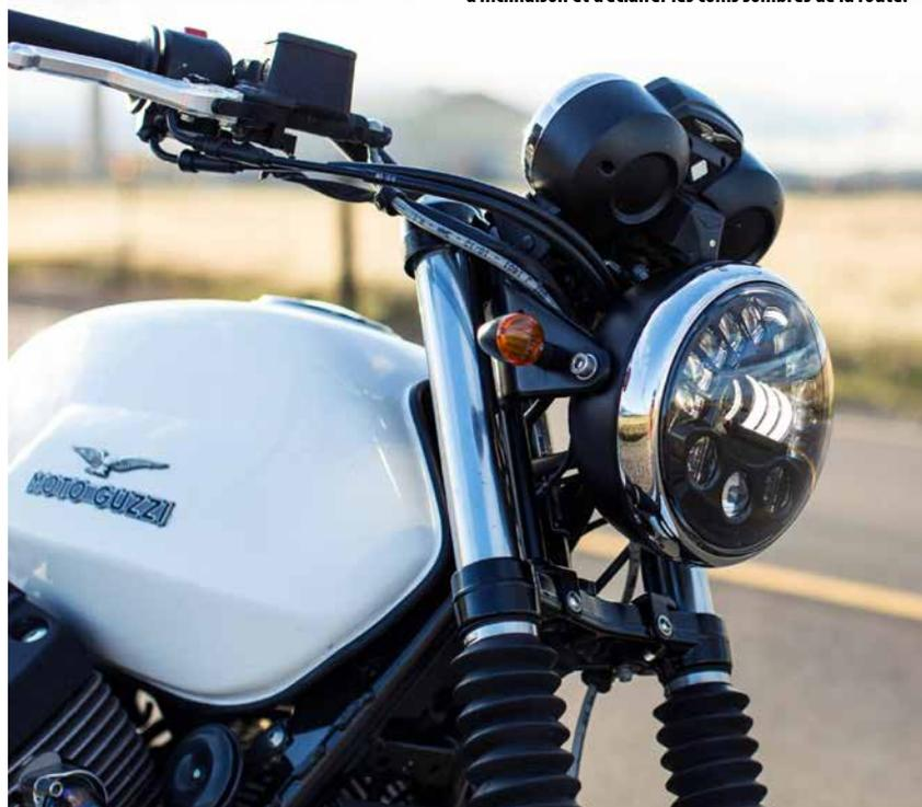
Les phares de moto à LED de la série Adaptive 2 de J.W. Speaker incorporent une technologie qui leur permet de détecter l'angle d'inclinaison et d'éclairer les coins sombres de la route.
