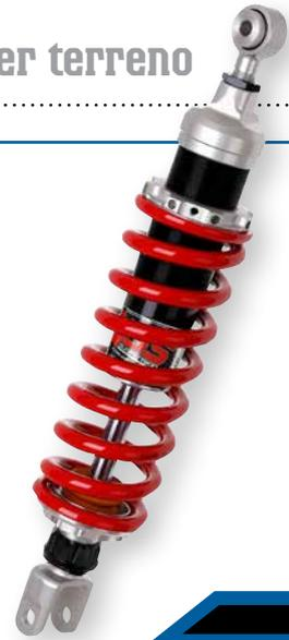
Al utilizar nitrógeno en el sistema de amortiguación, este amortiguador proporciona los mejores niveles de estabilidad y comodidad que uno pueda desear. El rebote, la precarga y la compresión pueden ajustarse al gusto y estilo de pilotaje de cada uno, así como al terreno. ■
