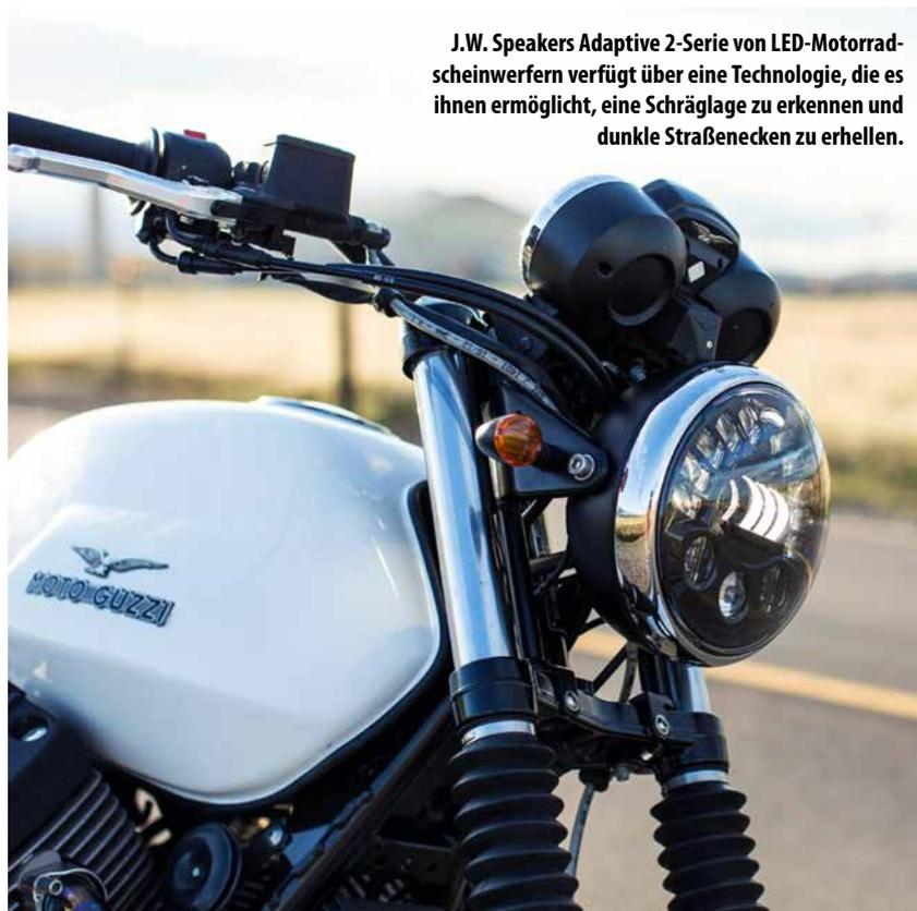
J.W. Speakers Adaptive 2-Serie von LED-Motorradscheinwerfern verfügt über eine Technologie, die es ihnen ermöglicht, eine Schräglage zu erkennen und dunkle Straßenecken zu erhellen.
