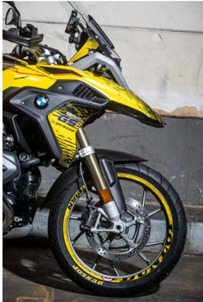
Dunlop habille une moto BMW R1250GS et une moto Honda Africa Twin de pneus Trailmax Meridian. Ces pneus sont prévus à 90 % pour la route et à 10 % pour le tout-terrain, ce qui en fait une solution parfaite pour les pilotes qui roulent généralement sur des surfaces pavées, mais souhaitent pouvoir pratiquer le tout-terrain de temps en temps.
