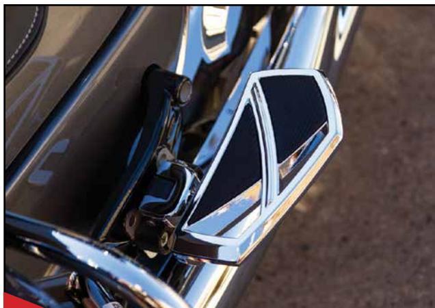
Les petites platines Phantom se montent au moyen des adaptateurs cannelés Kuryakyn et apportent au pilote ou au passager davantage de place pour les pieds que les repose-pieds standard, et ce avec plus d'élégance.
