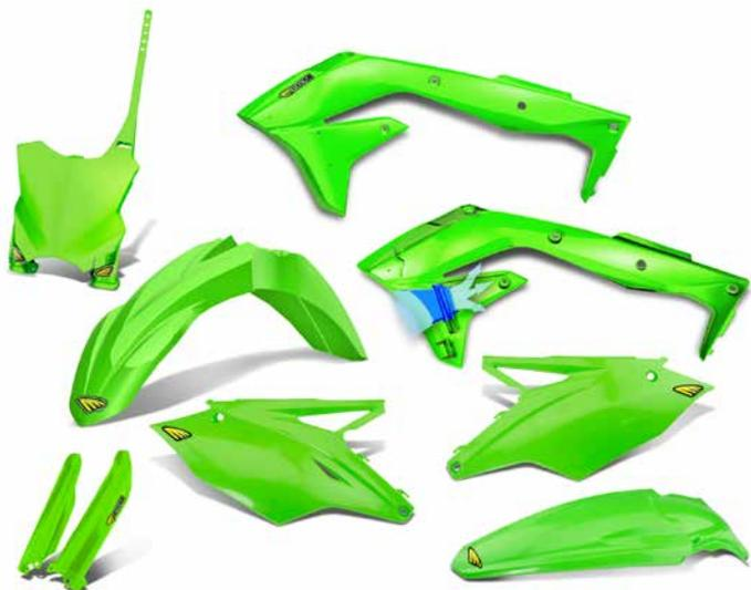
Les kits plastiques Powerflow renferment des ouïes de radiateur, des caches de filtre à air, un garde-boue avant hautes performances, un garde-boue arrière, des protections de fourche et la plaque à numéro avant légendaire Stadium de Cykra.
