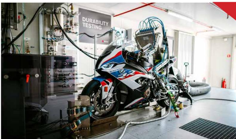
Todo el proceso de fabricación en Akrapovič se controla internamente, desde su propia fundición de titanio hasta la realización de tests específicos en bancos de pruebas para realizar los últimos ajustes.
