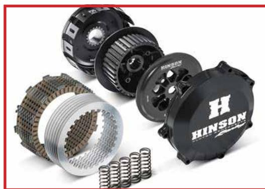
Un kit completo de embrague Hinson Billetproof incluye carcasa, tapa, maza interior, plato de presión, muelles, discos de fricción y discos separadores en acero.
