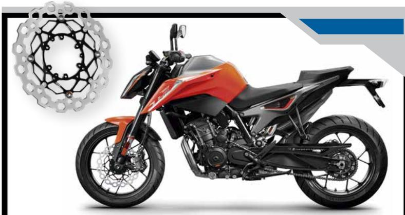
I nuovissimi dischi freno CUBIQ di Galfer sono compatibili con i migliori modelli sportivi e V-Twin sul mercato. CUBIQ prende il nome dalla sua forma, che imita la struttura cristallina delle molecole d'acciaio.
