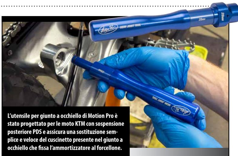
L'utensile per giunto a occhio di Motion Pro è stato progettato per le moto KTM con sospensione posteriore PDS e assicura una sostituzione semplice e veloce del cuscinetto presente nel giunto a occhio che fissa l'ammortizzatore al forcellone.
