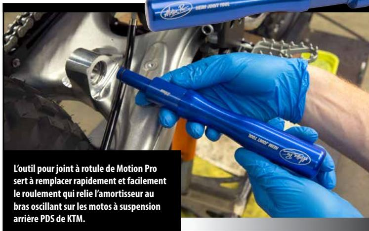
L'outil pour joint à rotule de Motion Pro sert à remplacer rapidement et facilement le roulement qui relie l'amortisseur au bras oscillant sur les motos à suspension arrière PDS de KTM.
