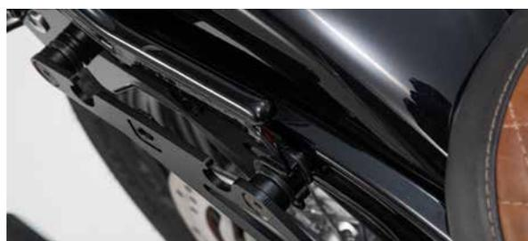
El soporte en acero acabado en pintura electrodepositada se funde con las líneas y estilo de la montura.
