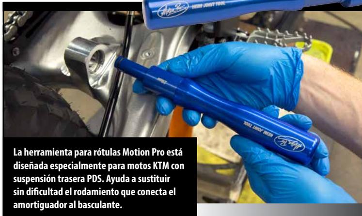
La herramienta para rótulas Motion Pro está diseñada especialmente para motos KTM con suspensión trasera PDS. Ayuda a sustituir sin dificultad el rodamiento que conecta el amortiguador al basculante.
