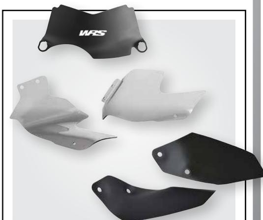
Para optimizar confort y aerodinámica en tus salidas y viajes, WRS ofrece adicionalmente deflectores de aire centrales y laterales.
