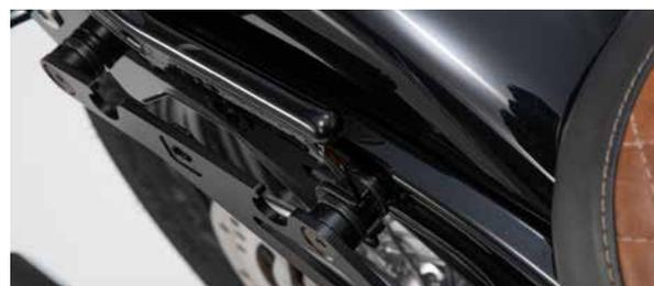
Die pulverbeschichteten seitlichen Halterungen werden sauber und unauffällig montiert.
