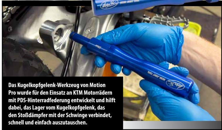
Das Kugelkopfgelenk-Werkzeug von Motion Pro wurde für den Einsatz an KTM Motorrädern mit PDS-Hinterradfederung entwickelt und hilft dabei, das Lager vom Kugelkopfgelenk, das den Stoßdämpfer mit der Schwinge verbindet, schnell und einfach auszutauschen.
