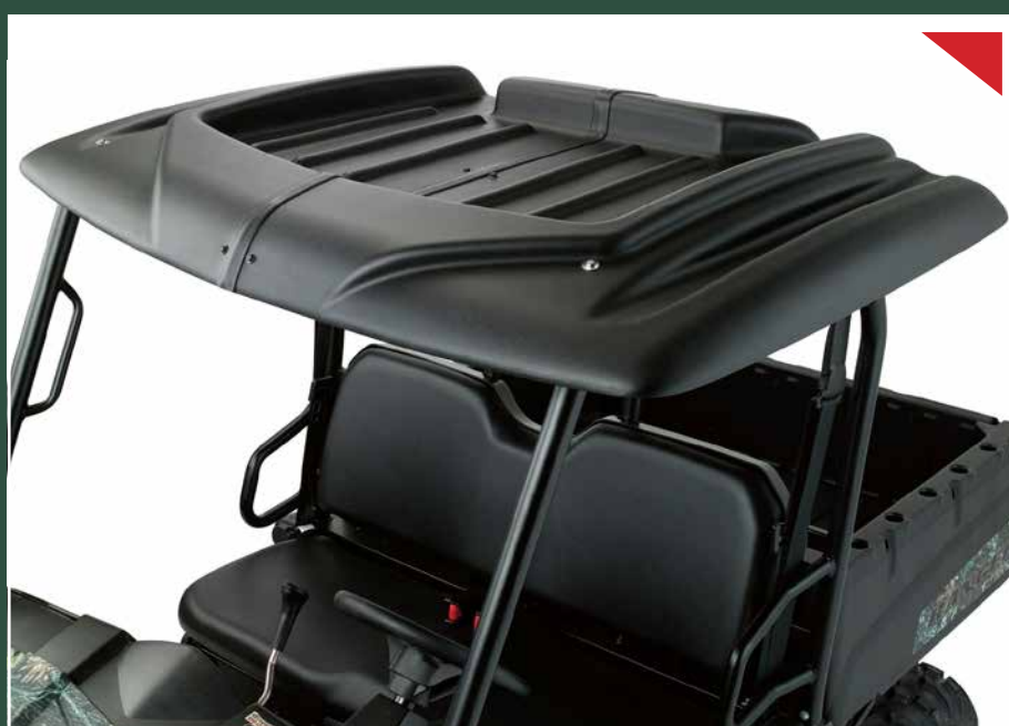
Le toit pour SSV deux pièces universel a un dessus rigide moulé en polyéthylène durable qui résiste au soleil persistant. Il est nanti de canaux pour que l'eau puisse être évacuée lorsqu'il pleut et d'un plateau de chargement moulé qui fait fonction d'espace de stockage supplémentaire.
