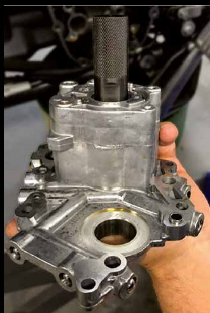
L'outil de contrôle de géométrie pour pompe à huile de JIMS sert à assembler le carter de distribution sur un moteur Milwaukee-Eight.
