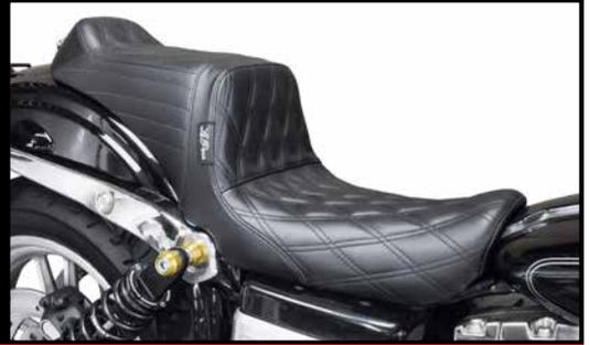
Jede LePera-Sitzbank beginnt mit einer Stahl-Grundplatte, die für eine perfekte, konturierte Passform auf dem Motorrad sorgt. Die natürlichen Dämpfungseigenschaften und die widerstandsfähige, aber schöne pulverbeschichtete Oberfläche werden durch eine mit Teppich verkleidete Unterseite verstärkt.
