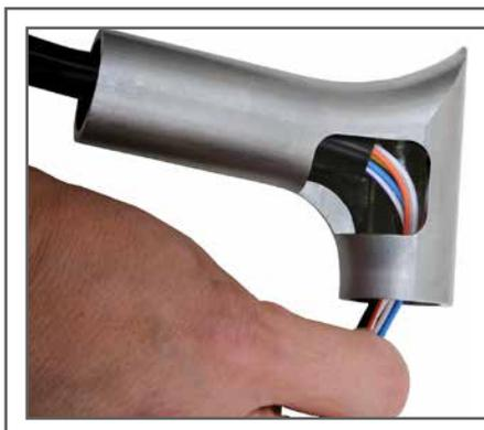
Die Lenker der EZ Install Serie von Fat Baggers Inc. verfügen über zwei einzigartige Features: ein extra großer interner Hohlraum, der es einfacher macht, den Kabelbaum durch die Lenkerbiegungen zu ziehen und das einzigartige, zweiteilige Design, das Lager- und Versandkosten reduziert.
