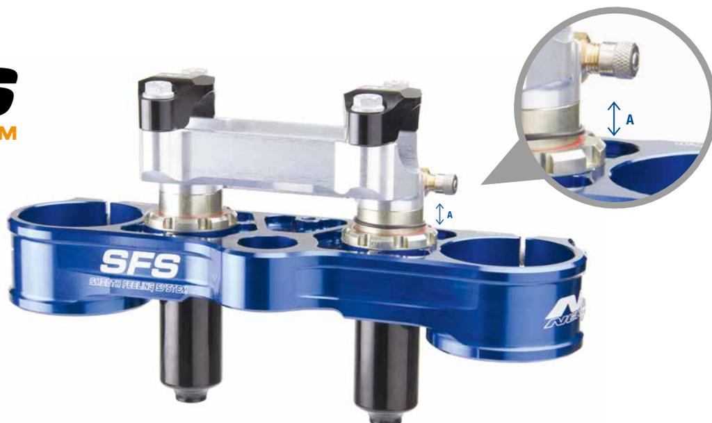
Les tés de fourches SFS Air ont une capacité d'absorption des chocs exceptionnelle, qui est due à un système air/huile avec une valve permettant aux pilotes de régler la pression de l'air.
